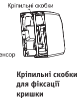
Мал. 4 Кріпильні скобки для фіксації кришки
